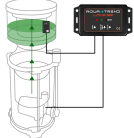
Rys. Przykładowe zastosowanie CAT-200DC do nadzorowania pracy pompy odpieniacza białek.
